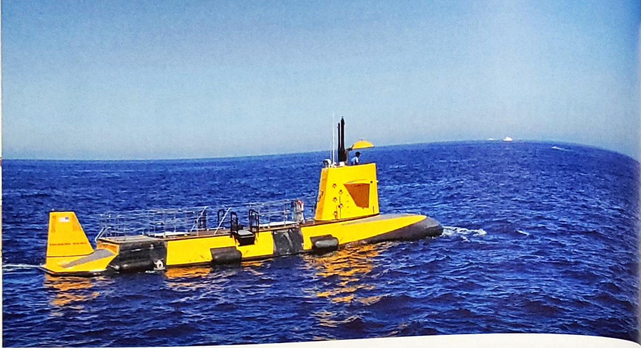
1 Das U-Boot Abyss kann bis zu 6 000 m tief tauchen.
